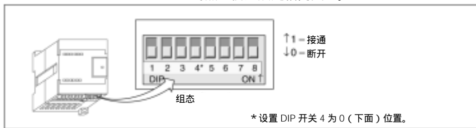
图 31 组态 EM231 热电偶模块的 DIP 开关
