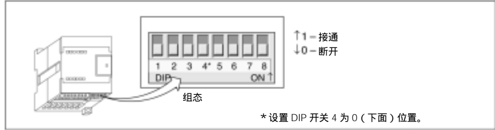
图 32 组态热电阻模块的 DIP 开关。
